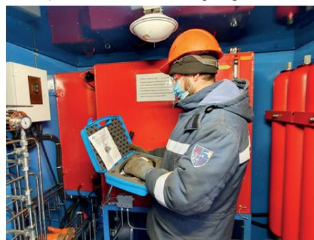
Проверка устройства для заправки пневмогидроаккумуляторов
